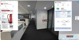
Nach der Überführung der digitalen Daten in einen digitalen Zwilling (3-D-Punktwolkenmodell) lassen sich die jeweiligen Leistungsstände abbilden und in einem virtuell begehbaren Realbildmodell zeigen.
