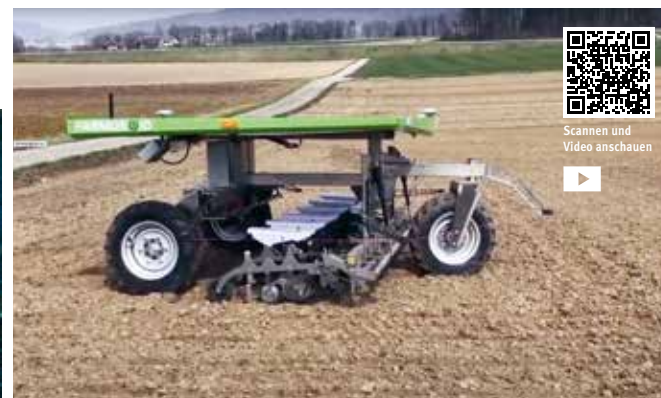
3 Feldroboter Farmdroid FD20 – autonome Saat von Zuckerrüben © Forschungsinstitut für biologischen Landbau (FiBL)
