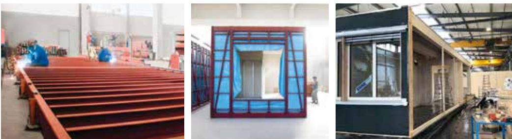
Abb. 9: Raummodule aus Stahl (ADK links, Mitte) und Holz (Erne rechts)
